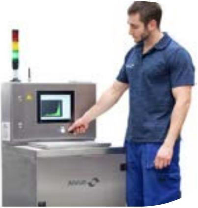
Ce système de surveillance de l'eau potable est conçu pour une surveillance en ligne rapide et précise de la contamination potentielle de l'eau potable par des substances radioactives bêta ou gamma.
