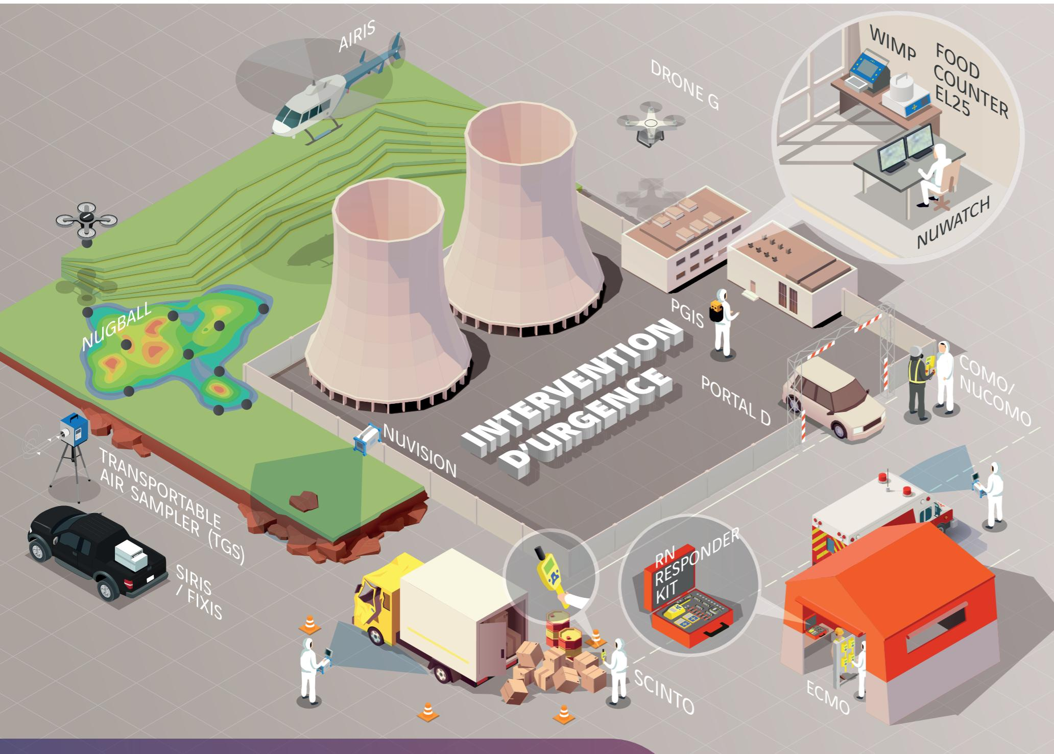
NuWATCH est un réseau global d'alerte précoce pour la surveillance et l'analyse des rayonnements. Plusieurs capteurs sont connectés à un logiciel central qui peut afficher une carte en temps réel des conditions radiologiques et avertir en cas de situation inhabituelle.
