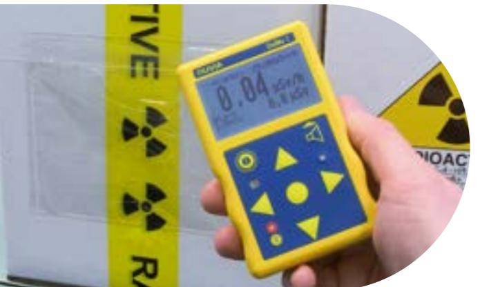
Un débitmètre de dose puissant pouvant être associé de manière routinière à de nombreux détecteurs et accessoires externes pour une gamme complète de mesures de la contamination et du débit de dose dans les situations d'urgence.
