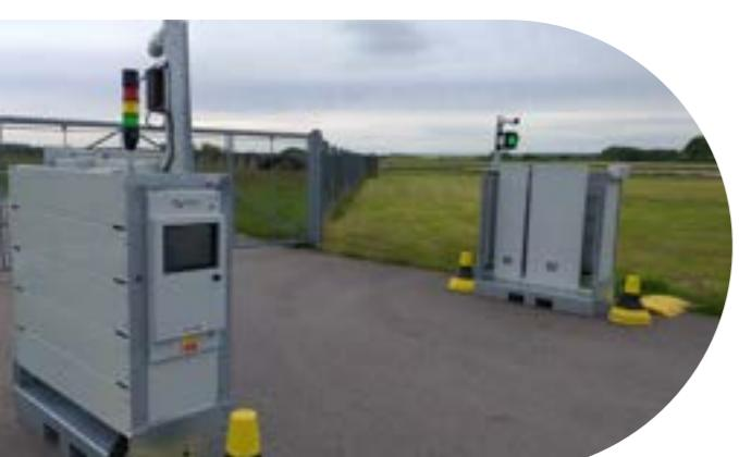
Moniteur portique très sensible développé pour le contrôle des véhicules et des cargaisons afin d'empêcher les mouvements illicites de sources radioactives.
