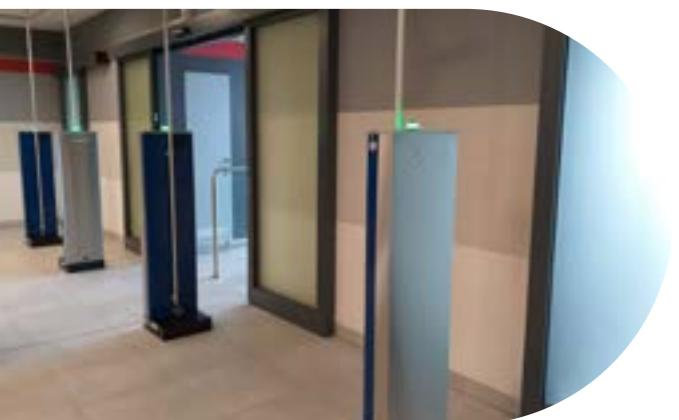
Un système modulaire compact de détection des rayonnements en cas d'urgence pour les piétons, à déploiement rapide.
