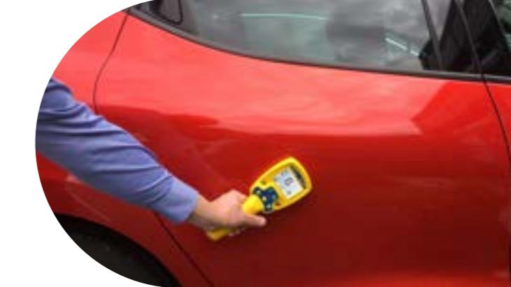
Un détecteur de contrebande pour un moyen rapide et sûr de contrôle des cavités à l'intérieur des véhicules.
