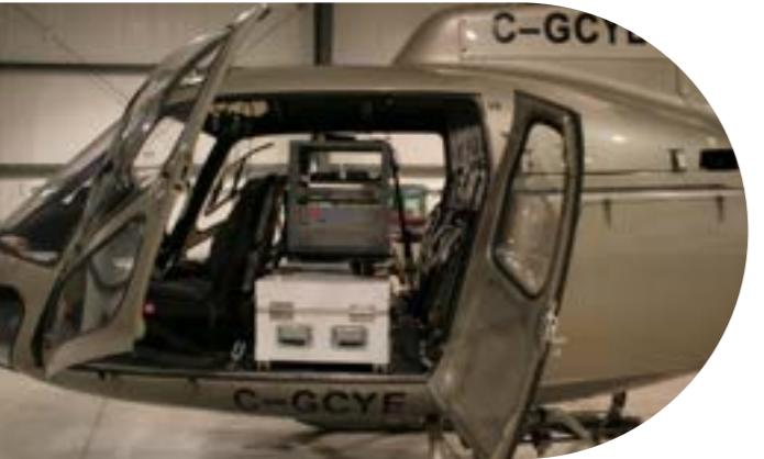
AIRIS est conçu pour la mesure des rayonnements aéroportés basée sur la spectroscopie gamma. Le système peut être installé sur des plateformes d'avions et d'hélicoptères.
